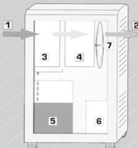
L'air humide en provenance du local est amené sur un évaporateur (batterie froide) au moyen d'un ventilateur. L'humidité se condense sur les serpentins de l'évaporateur et s'égoutte dans le bac à eau. Le condenseur réchauffe l'air à la température ambiante avant de le céder au local.
