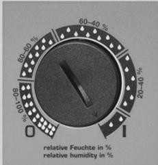
Die Luftentfeuchter der Serie KRG 50/70/100 verfügen über einen Hygrostaten, an dem ein gewünschter Feuchtigkeitswert eingestellt werden kann. Er bewirkt, dass sich der Luftentfeuchter einschaltet, wenn die Umgebungsfeuchte oberhalb des eingestellten Wertes liegt. Sinkt die Luftfeuchte unter diesen Wert, schaltet das Gerät vollständig ab. Der Hygrostat ist im Bedientableau seitlich am Gerät platziert.
