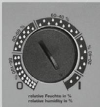
Les déshumidificateurs de la série KRG 50/70/100 sont équipés d'un hygrostat permettant de programmer une valeur de consigne pour l'humidité ambiante. Cet hygrostat commande automatiquement l'enclenchement de l'appareil lorsque l'humidité ambiante atteint une valeur supérieure à la valeur préréglée. Lorsque l'humidité de l'air atteint un taux inférieur à cette valeur, l'appareil s'arrête complètement. L'hygrostat est placé sur le panneau de commande sur le côté de l'appareil.
