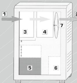
Die feuchte Raumluft wird mittels eines Ventilators über den am Kühlaggregat angeschlossenen Verdampfer geführt. Die Feuchtigkeit kondensiert an den Verdampfer-Schlangen und tropft als Wasser in den Wassereimer. Vor dem Austritt wird die Luft durch den Kondensator wieder auf die Eingangstemperatur erwärmt.
