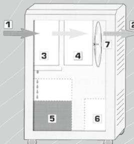
L'aria umida del locale è addotta tramite una ventola all'evaporatore allacciato al gruppo refrigerante. L'umidità si condensa sulle serpentine dell'evaporatore e gocciola sotto forma d'acqua nel secchiello. Prima dell'emissione, l'aria è riportata alla temperatura ambiente tramite il condensatore.
