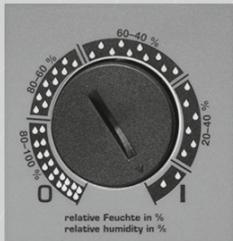
I deumidificatori della serie KRG 50/70/100 sono dotati di un igrostato tramite il quale è possibile impostare il tasso d'umidità desiderato. L'igrostato mette in funzione l'apparecchio se l'umidità ambientale supera il valore impostato. Quando l'umidità dell'aria scende sotto tale valore, l'apparecchio si spegne. L'igrostato è collocato nel pannello di comando a lato dell'apparecchio.
