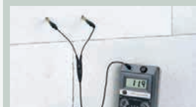
ANWENDUNG Messung mit einem Tiefen-Messelektrodenpaar M 21-250
