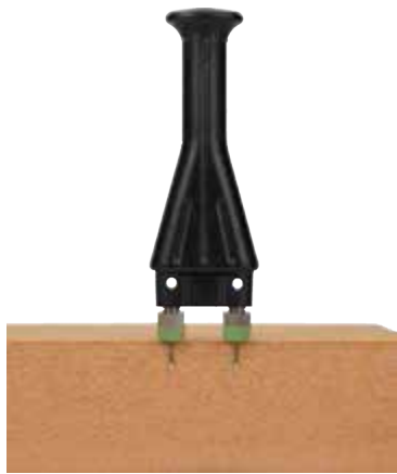
Einschlag-Elektrode M 20 mit speziell isolierten Elektroden-Muttern, die den Einfluss von Oberflächenfeuchte verringern
